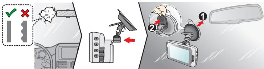
2. Lors du réglage de l'angle de montage, assurez-vous que le point de vue de la caméra est parallèle avec le niveau du sol, et que le ratio terre / ciel est proche de 6/4.
